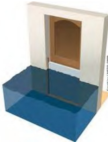
image : batardeau (MEDDE DGPR)
